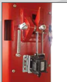
1. Sblocco sicure con elettro magnete 24V Electro magnet safety release 24V.
