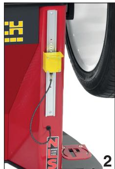
**IT** Sensore sonar radiale (1) e laterale (2) per la misurazione dei valori di eccentricità.
